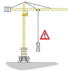
Figura 7. Aplicação DSP como limitador de carga.
