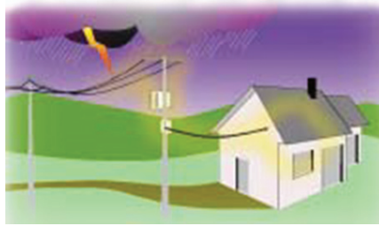
Descarga sobre linha aérea.
